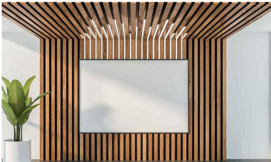
Fabricados en MDF con terminación en vinilo para instalación en interiores, que nos permiten hacer divisiones en todo tipo de estancias (instalaciones al aire) y no es necesario apoyarlos sobre una pared. Su núcleo de MDF está protegido por una lámina de vinilo resistente a la humedad y lavable. Gama de 4 colores a elegir en el formato de 38x30 y 2 colores en 70x30.
